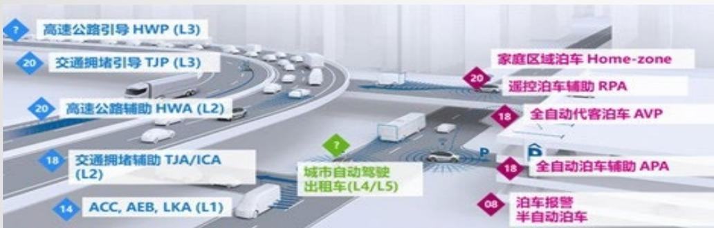
**L2：方向盘和加减速提供两项自动操作，如自适应巡航+车道保持等。**
